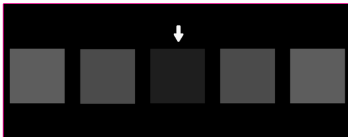
HDMI监视器上用于校准暗部细节的测试图案。
