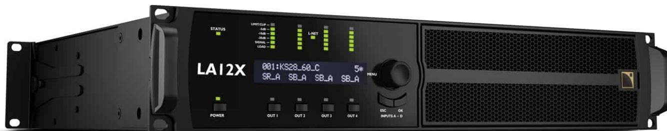
Le LA12X est un contrôleur amplifié conçu pour alimenter les plus grandes enceintes du catalogue L-Acoustics®. Il est doté d'une alimentation à découpage (SMPS : Switched Mode Power Supply) avec correction du facteur de puissance (PFC), contrôlée par un processeur de signal numérique (DSP). Cette alimentation permet au LA12X de délivrer une puissance de sortie élevée (12 000 watts) sur des temps records.
