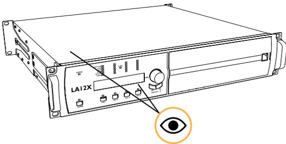
châssis, panneau en Lexan, écran LCD, et LEDs sont intactes
