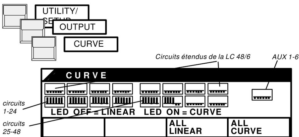
Pour tous les circuits sélectionnés en "CURVE", les LED's correspondantes s'illuminent et le graphique affiche une barre montante. Les modifications peuvent être effectuées par les touches Flash. Les changeurs de couleurs et autres effets doivent être contrôlés de façon "LINEAIRE" (LINEAR).
