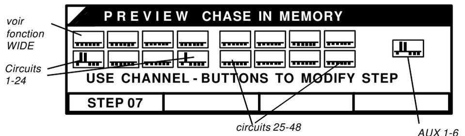
Les pas ON/OFF sont affichés par des bar-graphes, et sur les LED's de circuits. Les modifications sont effectuées par l'intermédiaire des touches Flash.
