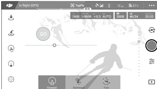
3. Appuyez sur la cible et attendez que le bouton « GO » s'affiche. Appuyez sur le bouton « GO » pour confirmer la sélection. L'appareil vole automatiquement vers la cible sélectionnée. Un message s'affiche si la cible est inaccessible. Dans ce cas, sélectionnez une autre cible et réessayez. Vous pouvez changer de cible en cours de vol en appuyant sur l'écran.
