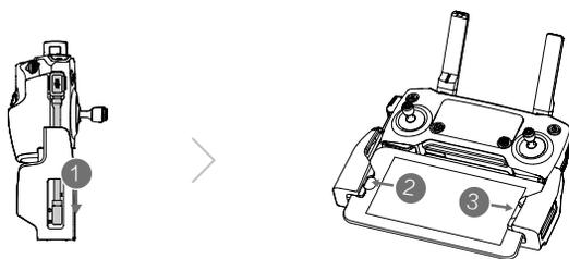
Consultez le schéma ci-dessous pour remplacer le câble RC. La glissière pour câble RC doit être remplacée si vous utilisez un câble RC prise USB Type-C.
